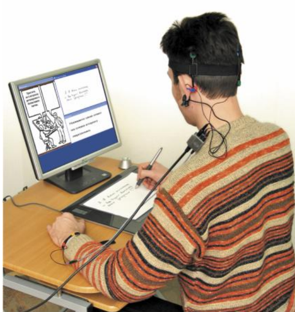
Рис. Внешний вид рабочего места и проведения исследования на примере проективной методики «Деловые ситуации». Испытуемый письменно выполняет задания, предъявляемые ему на экране монитора, с использованием графического сенсорного планшета и специальной ручки. На испытуемом установлена специальная укладка для регистрации физиологических сигналов.
